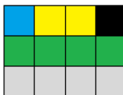
Abbildung 4: Alignment der Daten durch Padding(schwarz)
