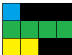
Abbildung 5: Speicher mit jeweils einem char, int und short nach Padding
