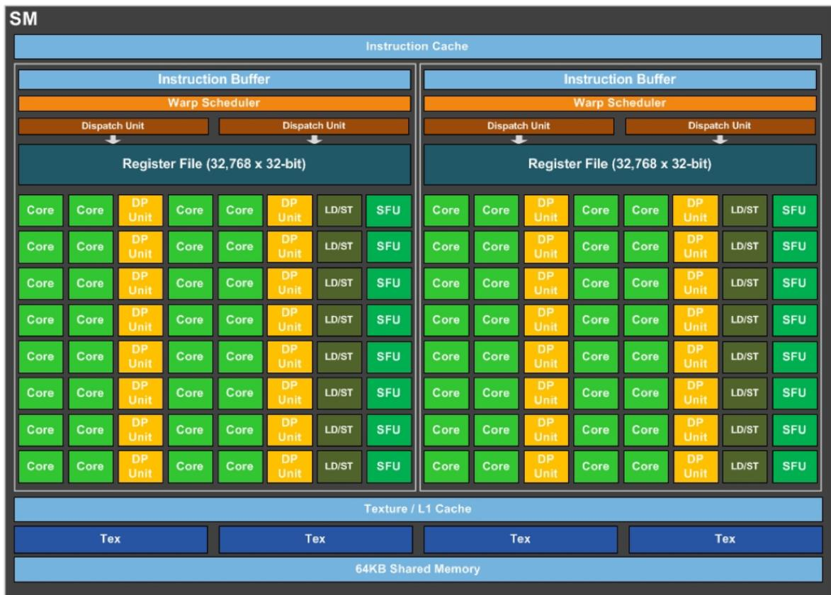
Abbildung 2.1: Aufbau eines SM bei der Tesla P100, [http://cdn.wccftech.com/wp-content/uploads/2016/04/gp100\\_SM\\_diagram.png](http://cdn.wccftech.com/wp-content/uploads/2016/04/gp100_SM_diagram.png)
