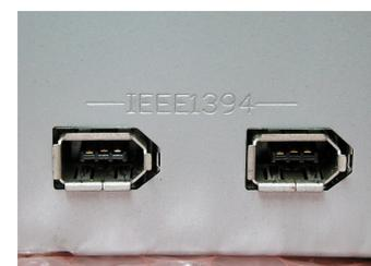
Zielsetzung in direkter Konkurrenz zum USB-System. Bereits in der ersten Spezifikationsstufe stand der FireWire-Anschluss in den Geschwindigkeitsklassen S100, S200 und S400 dem Konsumenten mit einer Datenübertragungsrate von 12, 25 und 50 MB/s zur Verfügung. Auch „Hot Plug / Unplug“ ist bei diesem Anschluss möglich und die Geräte können beim laufenden Betrieb angeschlossen werden und werden dann automatisch erkannt.
