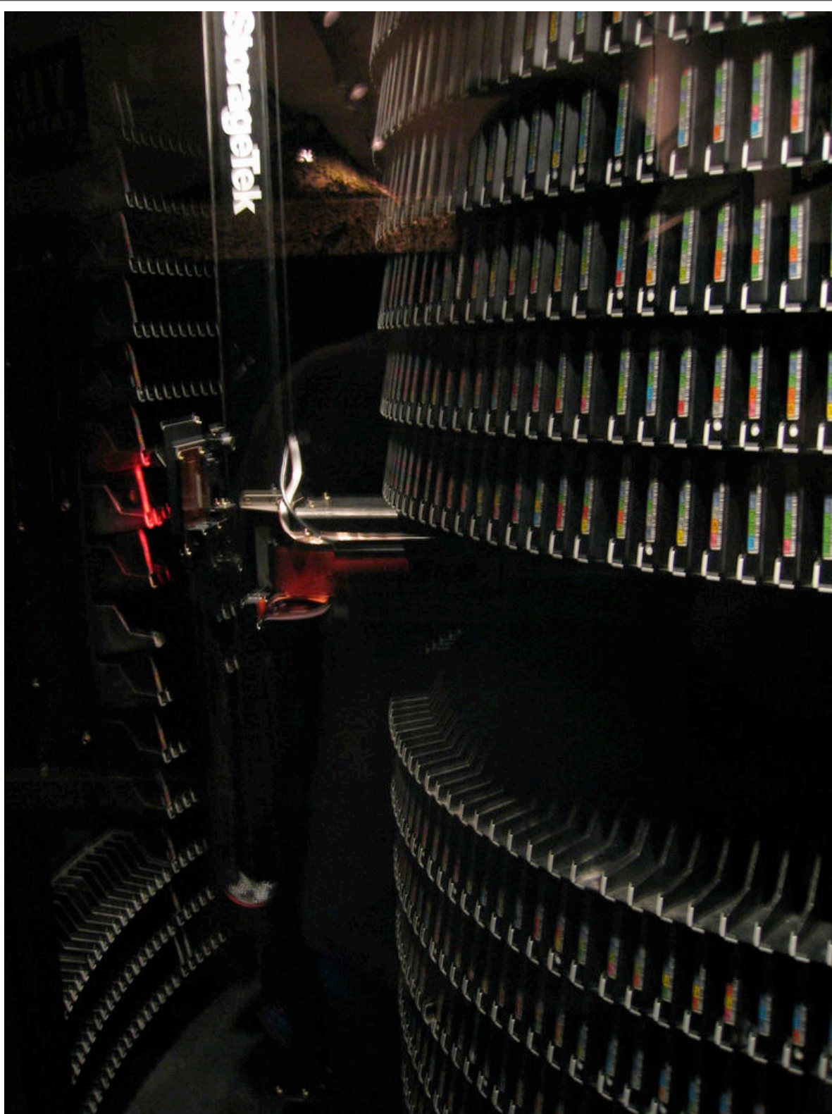
Rechts: Roboterarm, zum Befüllen der Laufwerke, mit leeren Laufwerkseinschüben. Links sind die Tapes in einem Silo aufbewahrt.
