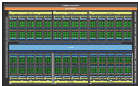
Abbildung: GTX 1080 Ti Architektur: https://bilder.pcwelt.de/4073108_original.jpg
