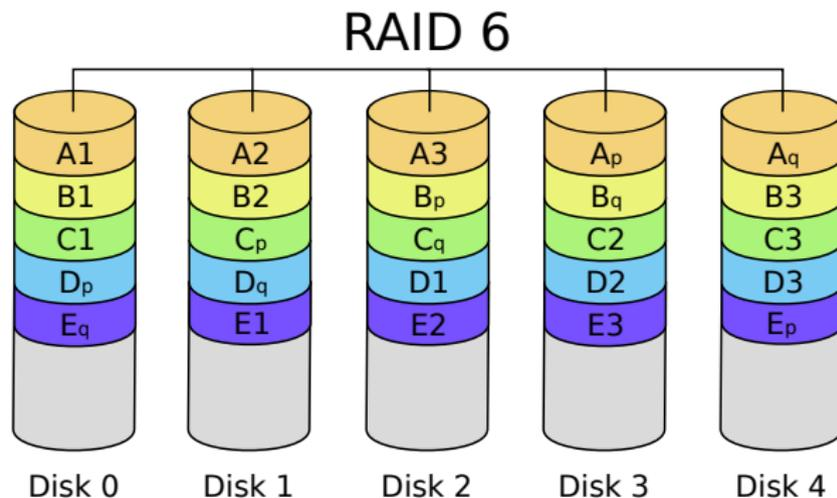
**Abbildung:** RAID 6 – Block-Striping mit verteilter doppelter Parität [4]
