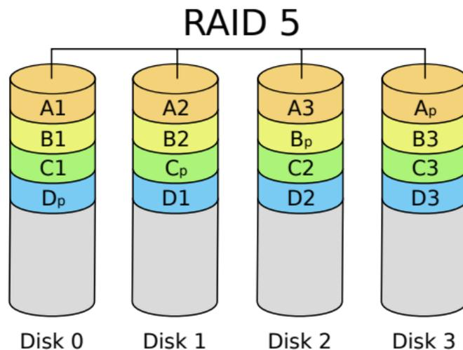
**Abbildung:** RAID 5 – Block-Striping mit verteilter Parität [4]
