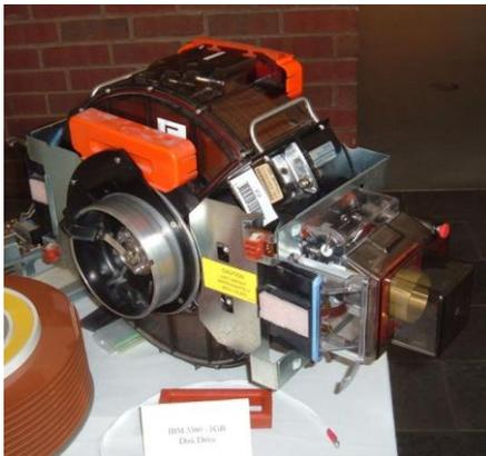
Ein(!) Modul einer IBM 3380 Platteneinheit (1987).
